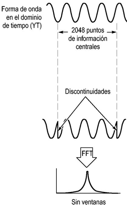
La aplicación de una ventana a la forma de onda  $Y(t)$  cambia la forma de onda para que los valores inicial y final queden próximos entre sí, lo que reduce las discontinuidades.
