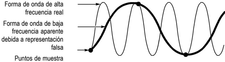
El osciloscopio representa señales con exactitud, pero esto se ve limitado por el ancho de banda de la sonda y del osciloscopio, y por la velocidad de muestra. Para evitar representaciones falsas, el osciloscopio debe realizar muestras de la señal a una velocidad superior al doble de la del componente de frecuencia más alta de la señal.
