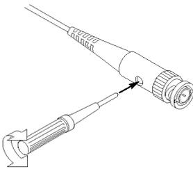
4. Si es necesario, ajuste la sonda. Se muestra la sonda P2220. Repita las veces que sea necesario.
