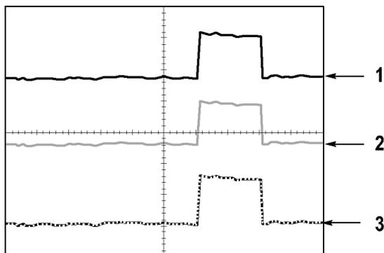
1. Una forma de onda sólida indica una presentación de forma de onda (activa) de canal. La forma de onda permanece sólida cuando la adquisición se detiene si no se han cambiado controles que hagan que la precisión de la presentación sea incierta.
