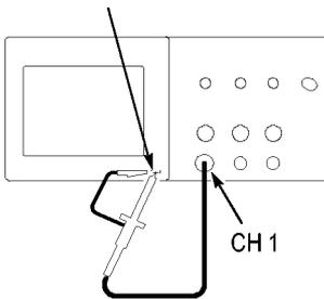
2. Establezca el conmutador de la sonda P2220 en 10X y conecte la sonda al canal 1 del osciloscopio. Para ello, alinee la ranura del conector de la sonda con la llave del BNC de CH 1, presione hasta conectar y gire a la derecha para fijar la sonda en su sitio.
