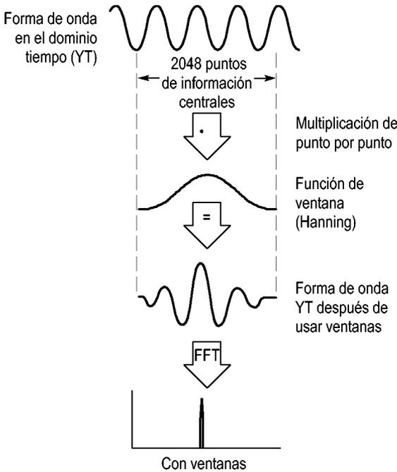
La función FFT matemática incluye tres opciones de ventana FFT. Existe un equilibrio entre la resolución de la frecuencia y la precisión de la amplitud en cada tipo de ventana. La ventana que se utiliza está determinada por lo que desea medir el usuario y por las características de la fuente de señal.
