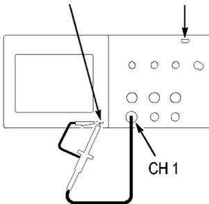
1. Pulse la opción **CH 1 MENU ▶ Sonda ▶ Voltaje ▶ Atenuación** y seleccione la opción **10X**. Establezca el conmutador de la sonda P2220 en 10X y conecte la sonda al canal 1 del osciloscopio. Si utiliza la punta de gancho de la sonda, asegure una conexión correcta insertando firmemente la punta en la sonda.
