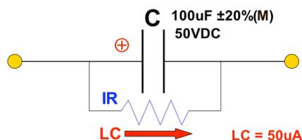
El valor de la resistencia está en el orden de los  $M\Omega$ , por lo que la corriente es del orden de los  $\mu A$ . Se calcula mediante los parámetros  $C$  y  $V_{dc}$  del condensador, multiplicados por un factor especificado en los catálogos.
