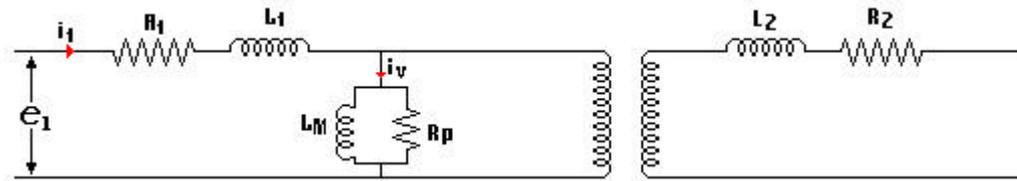
Conectemos un vatímetro al primario. Este nos indicará una cierta potencia  $P$  que será la potencia de entrada. Como no sale ninguna potencia, es evidente que toda la que entra se perderá. Esta potencia perdida será la suma de las pérdidas en el cobre y las pérdidas en el hierro.
